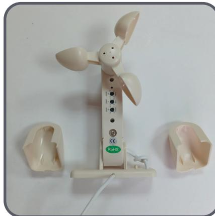
Снимите боковые крышки мест крепления модуля.
