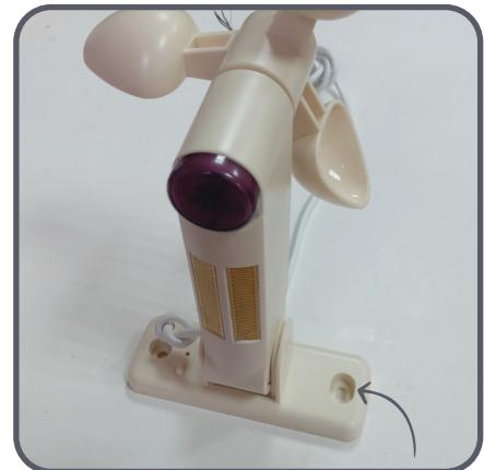
Закрепите модуль с помощью саморезов в правильно выбранном месте через монтажные отверстия в корпусе. Установите боковые крышки на место.
